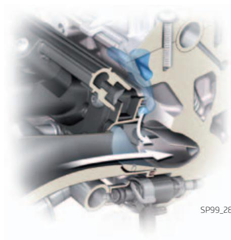
В атмосферном режиме картерные газы из маслоотделителя тонкой очистки отводятся в модуль впускного коллектора.
